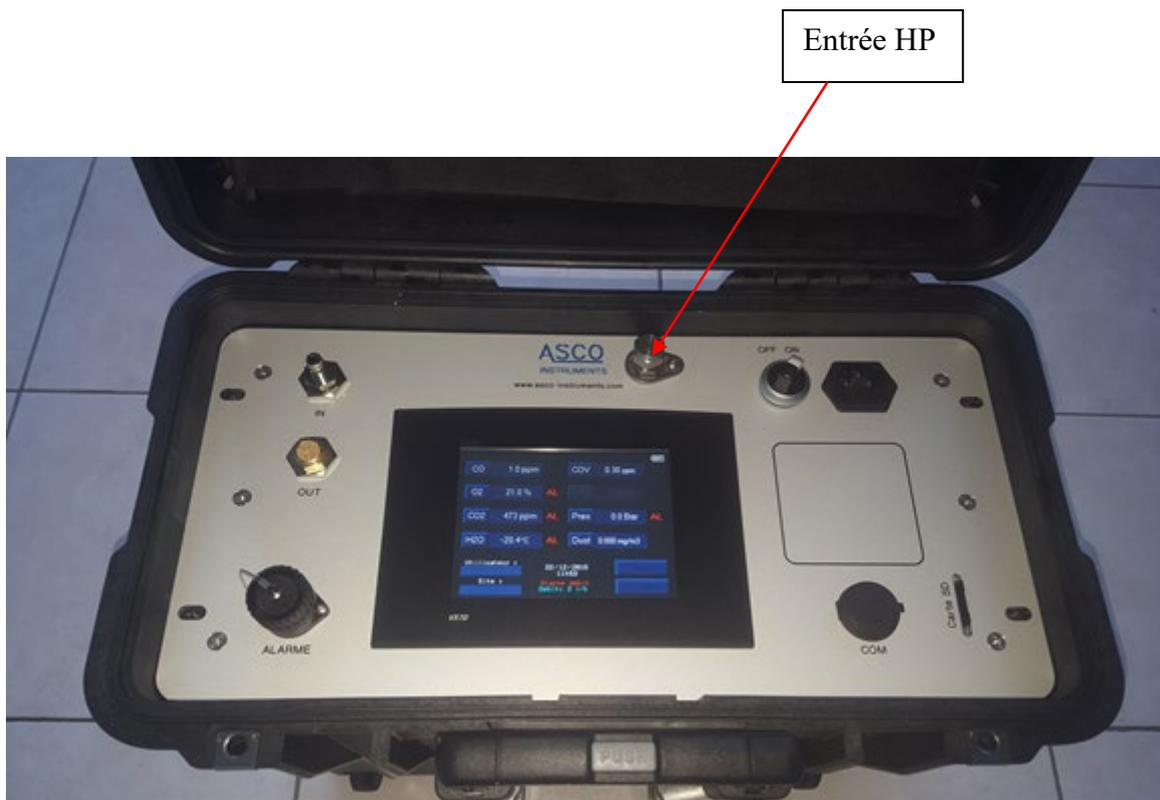
Cette entrée permet de connecter un réseau en pression à 300 bar.
