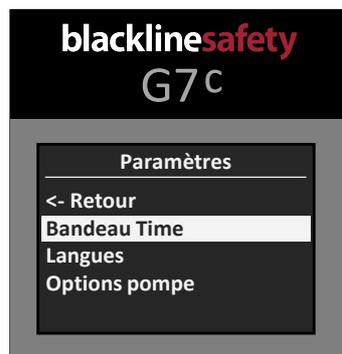
**Bandeau Time** : Réglage du bandeau supérieur de l'appareil.
