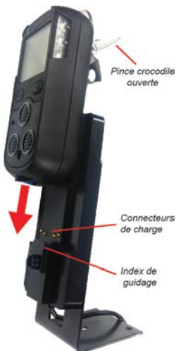
Fig. 6-6 Connecter le PS200 au banc de charge
