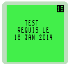
Fig. 2-6 Date requise de test de déclenchement au gaz
