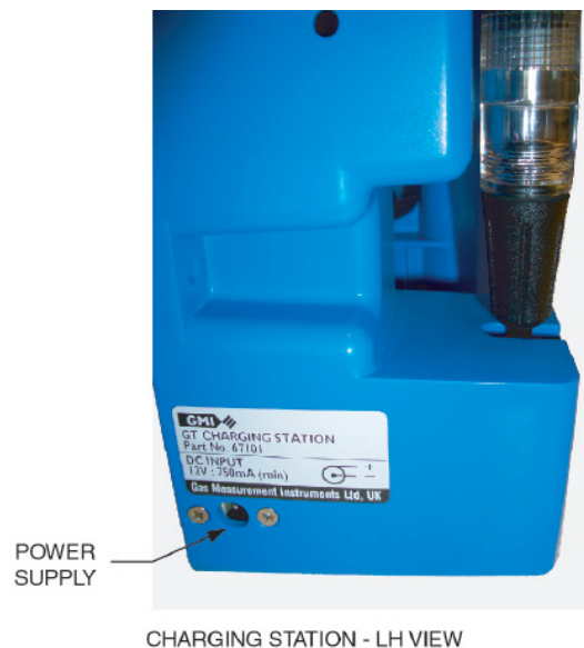
Figure 6-12: Alimentation électrique de la station de recharge
