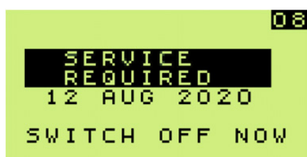
Figure 3-12: Entretien dû - Mise hors tension
