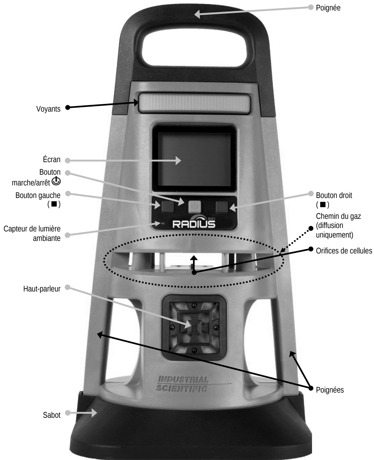
Figure 3.1.A Présentation des composants du Radius BZ1 (vue avant, diffusion)
