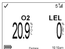
Accueil pour deux cellules installées
