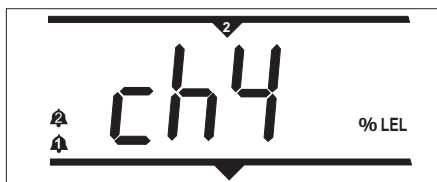
Figure 3.3 Exemple de système en état d'alarme
