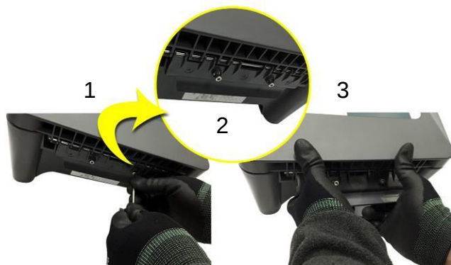
Figure 9. Dévissage des deux vis de sécurité et ouverture du coffret
