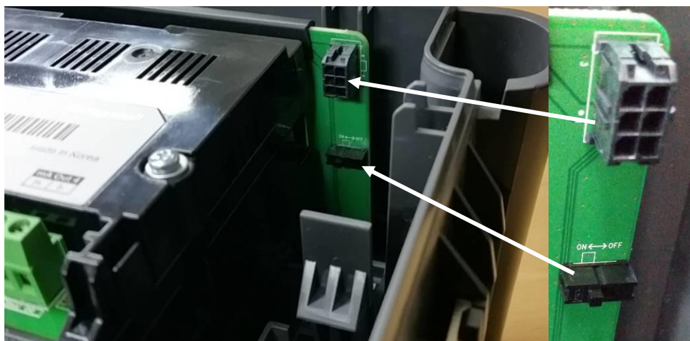
Figure 18. Interrupteur et connecteur de la batterie
