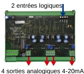
Figure 20 : principe du module de 4 sorties analogiques.
