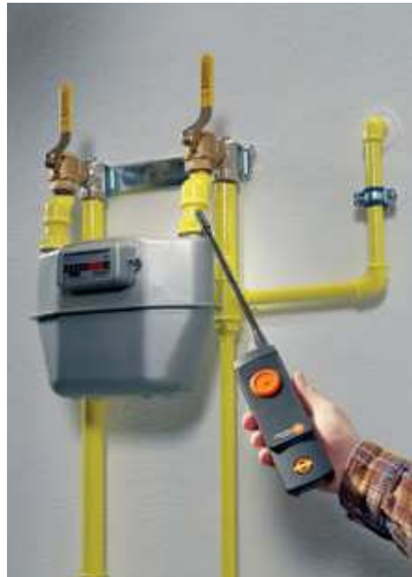
Contrôle d'étanchéité sur des conduites de gaz d'installations domestiques
