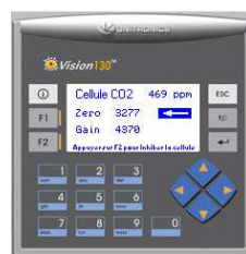
Configuration de chaque voie de mesure
